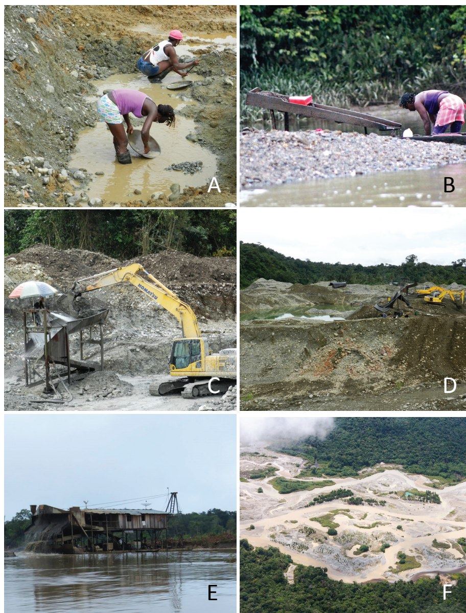
Figura 1. Técnicas para la extracción informal de oro y platino en ecosistemas naturales del Chocó, Colombia: Minería con instrumentos artesanales (A-B), retroexcavadoras y motobombas de alta presión (C-D), y dragas de succión (E-F).
