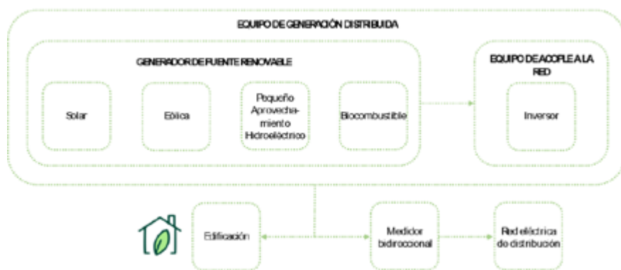
Figura 1. Equipo de generación distribuida (fuente: Elaboración propia en base a SEN, 2019).
